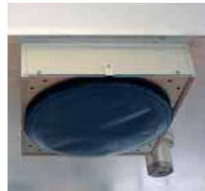
Unterseitig an der Sandwichplatte angebrachte Luftlager-Kassetten
