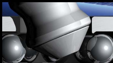
Insertion et retrait sans blocage grâce au profil optimal de la tirette de serrage (seulement pour les modules Gonzales).
