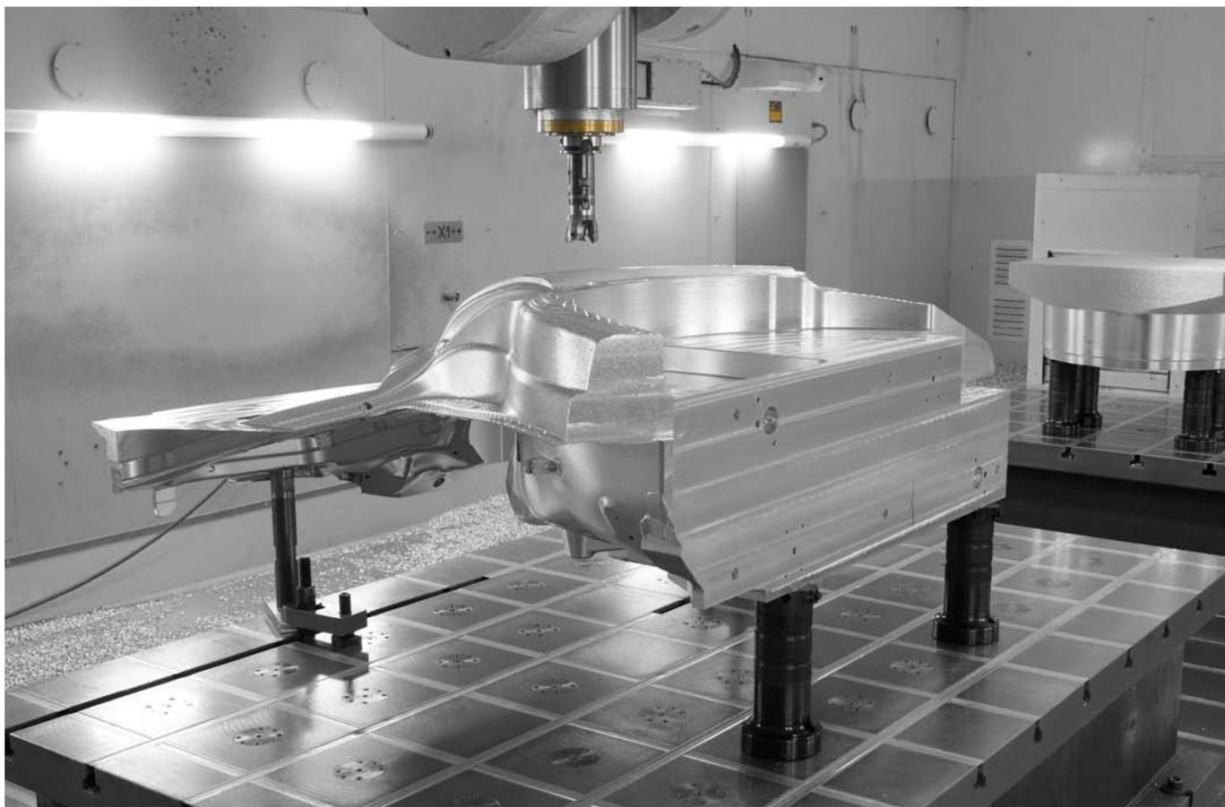
Serrage direct de pièces de grandes dimensions en aluminium. Les modules de bridage point zéro dans le plateau de serrage associés à des éléments à poser ou intermédiaires du système modulaire de bridage du point zéro permettent un bridage flexible.
