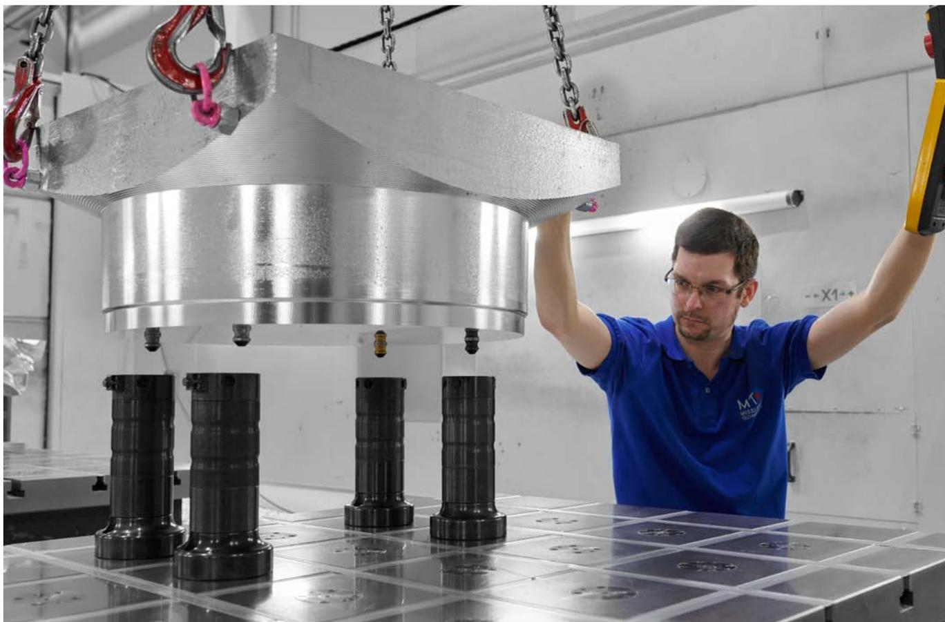
Réduire au minimum les temps d'équipement grâce à la technique de bridage du point zéro d'AMF :
