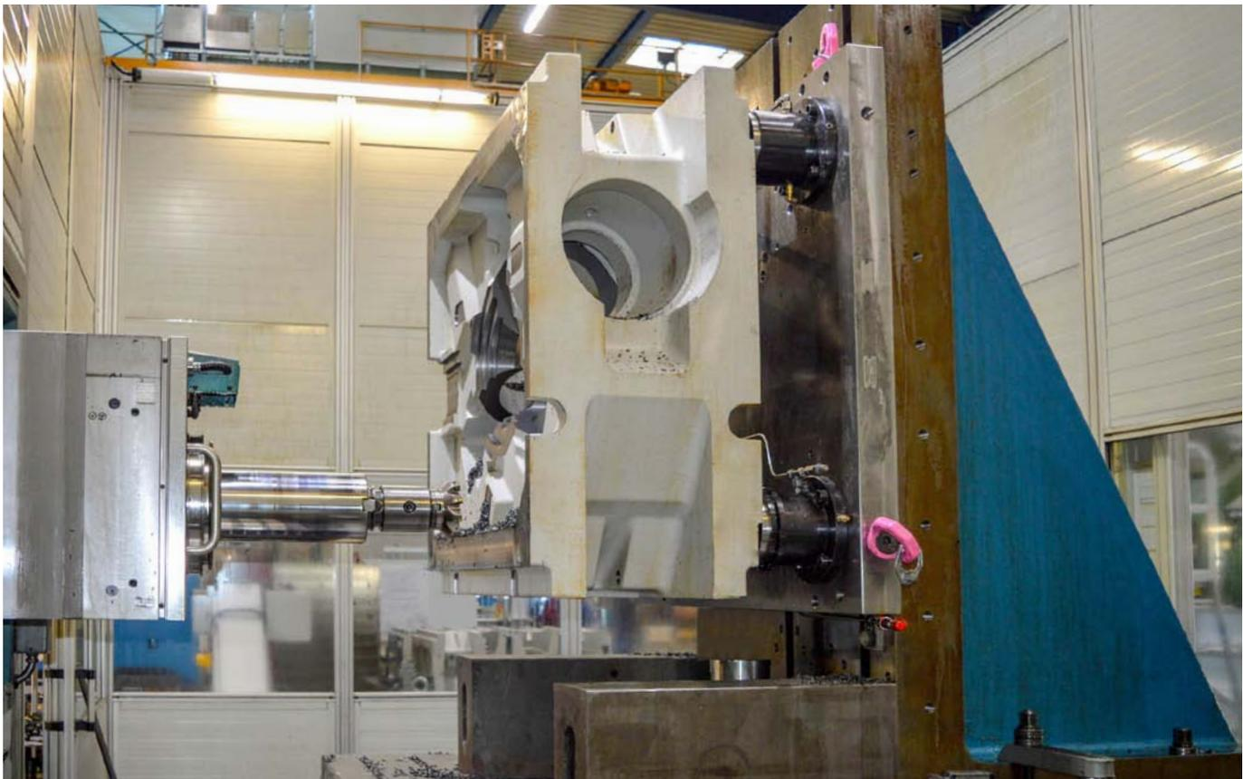
Tension directe de la pièce sur un centre d'usinage horizontal.
