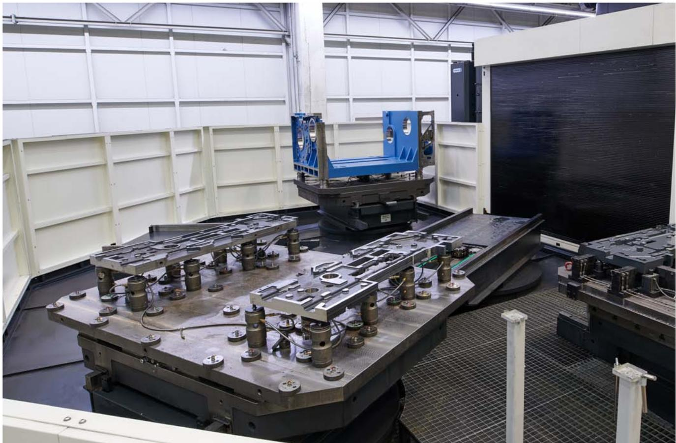
Les tours de serrage à point zéro sont adaptées de manière flexible à chaque pièce à usiner par un simple déplacement.
