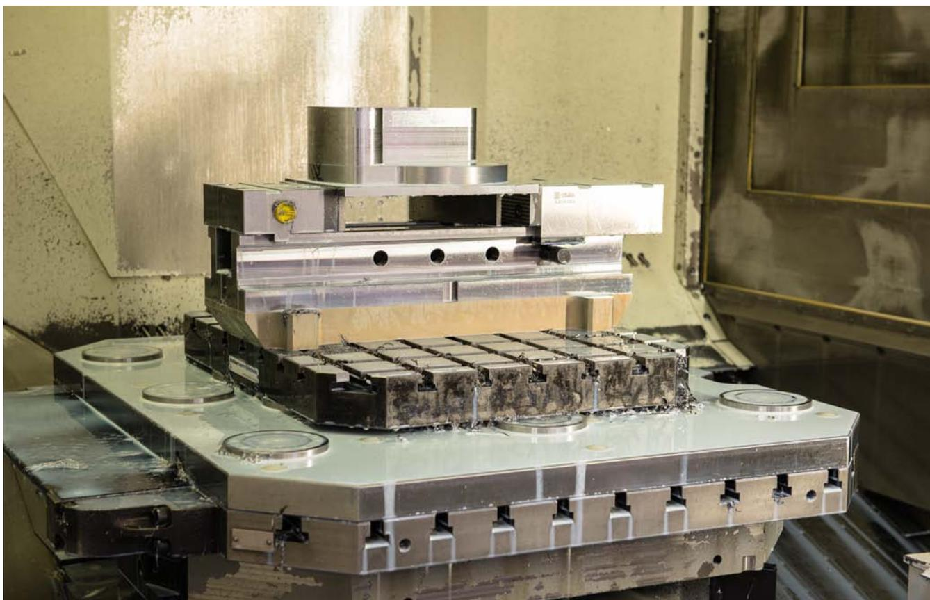
Grâce à la faible hauteur de montage de nos modules de serrage, le montage du système de bridage s'adapte soupement à la hauteur d'usinage nécessaire et à la pièce.
