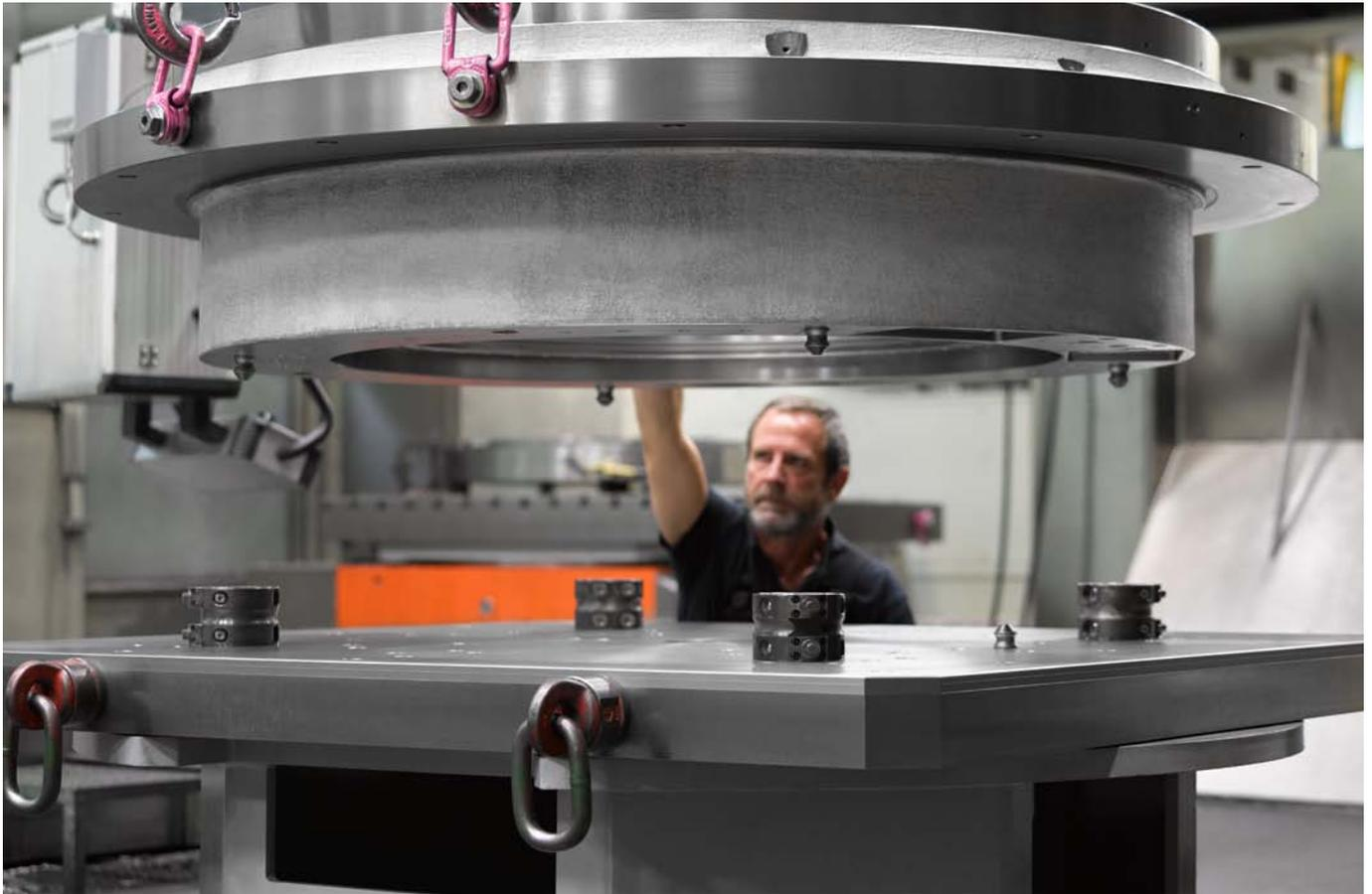
Optimisation du temps d'équipement lors de la fabrication en petites séries grâce à un serrage direct et variable du composant. Les modules de serrage doubles peuvent être adaptés rapidement à différents composants grâce à leur changement de position simple.
