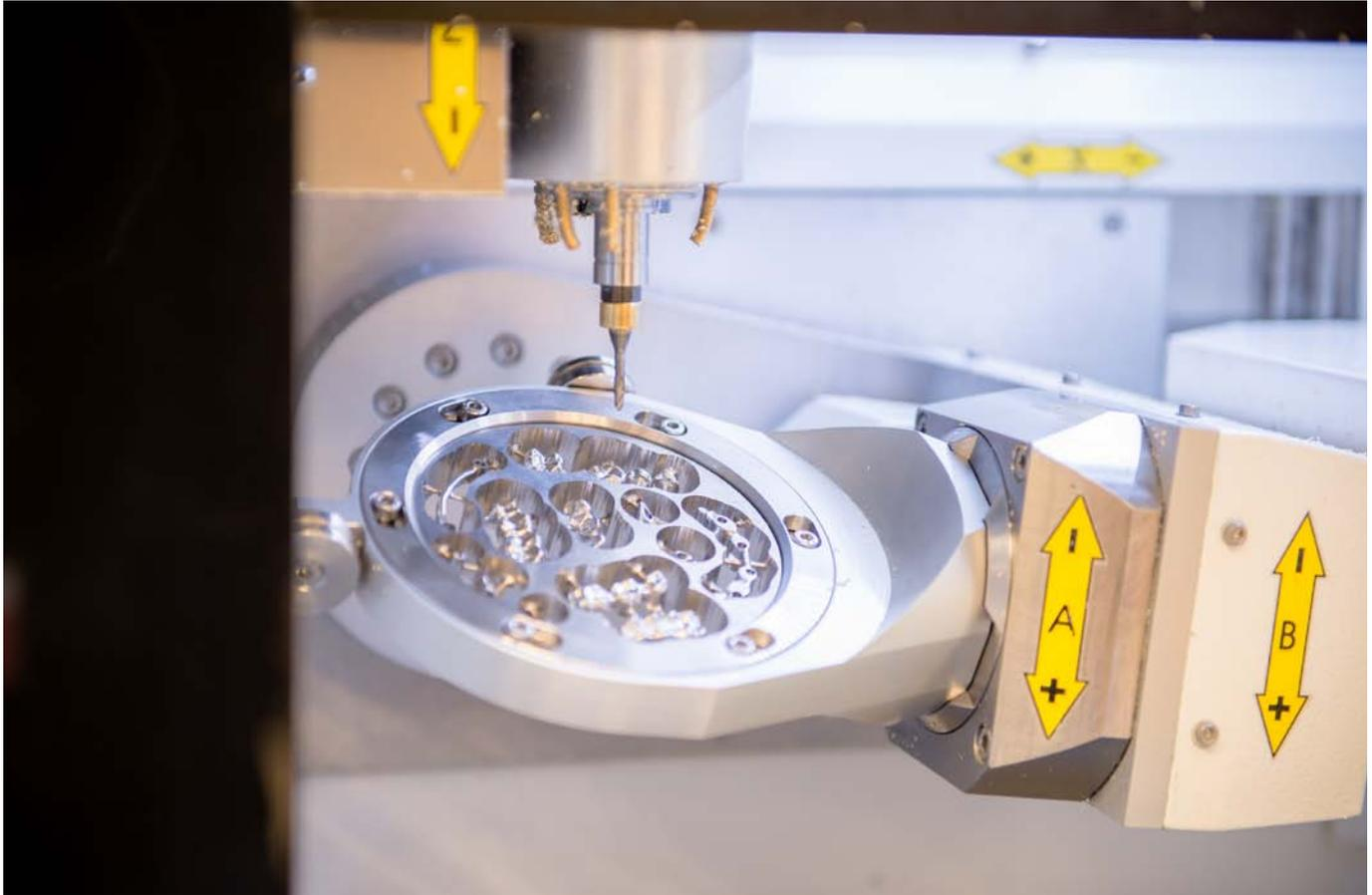
Chargement et serrage totalement automatisés de rondelles lors de la fabrication d'implants dentaires.
