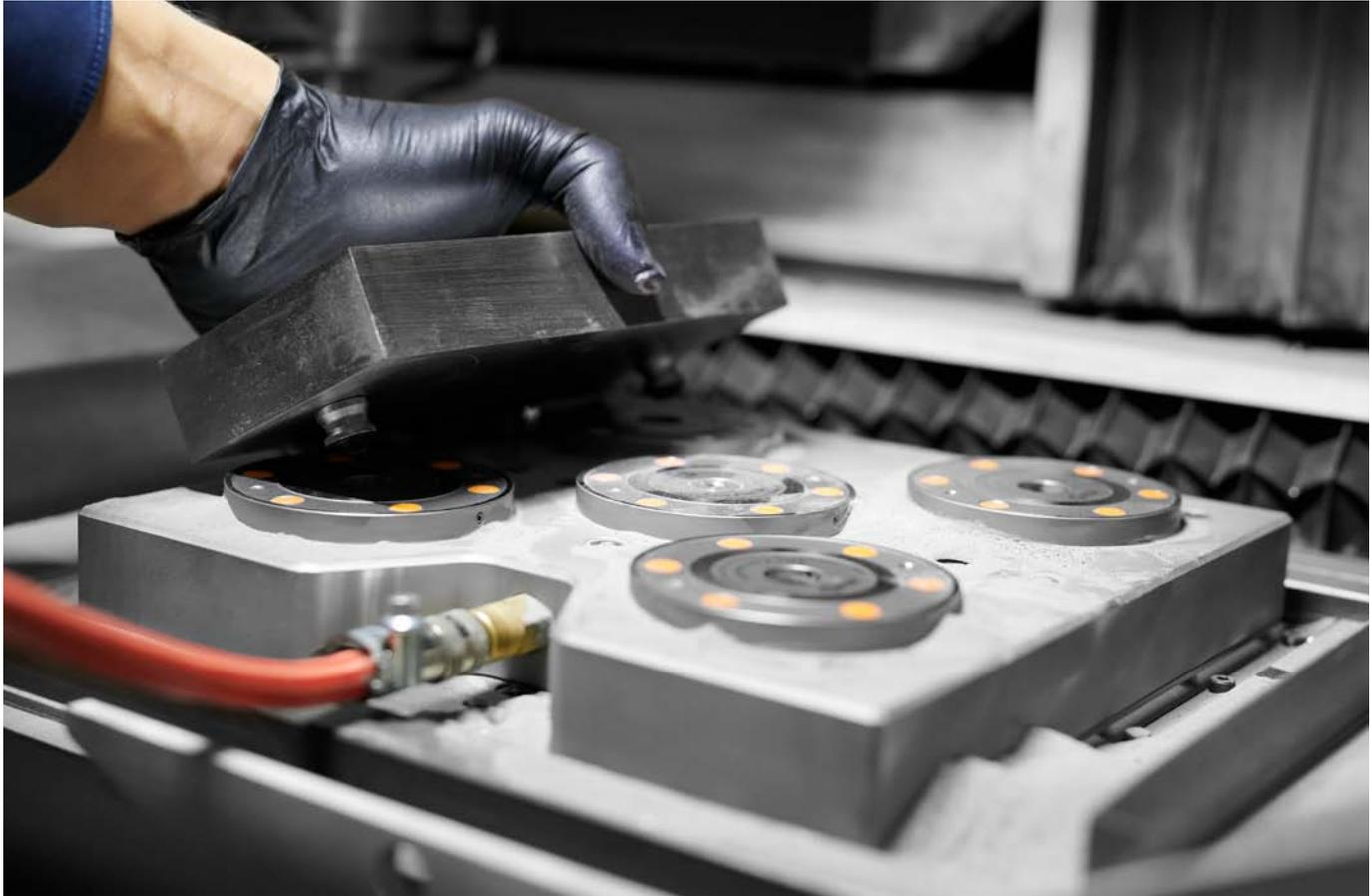
Zero-Point-Systems AMF pour la fabrication additive.
