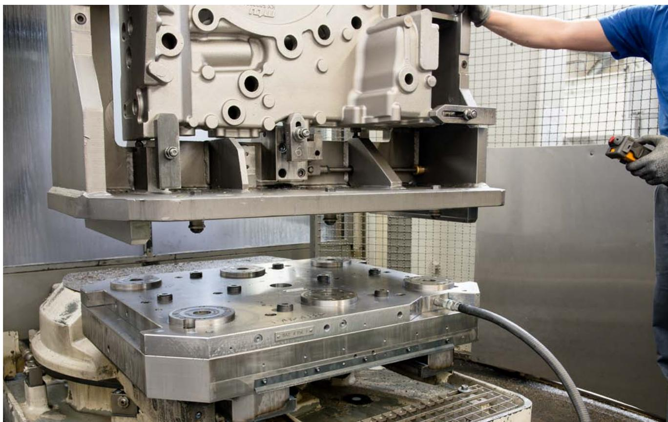
Le système de tirette de serrage en deux parties avec grande insertion de réception et la structure du module sans cage à billes permettent un changement ergonomique et sans blocage du dispositif.
