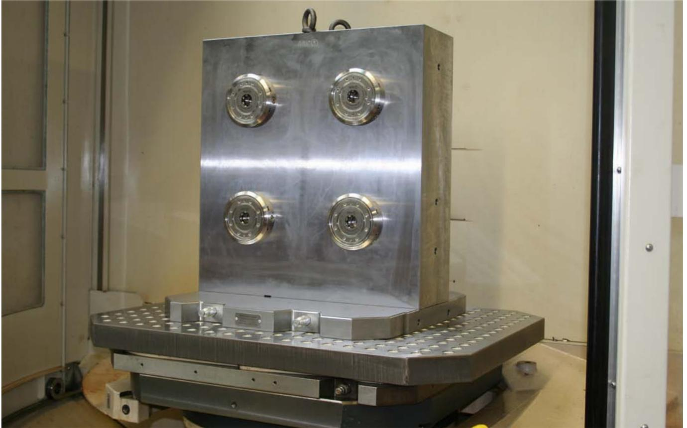
Modules de serrage à intégrer en tant que version de flasque pour l'installation sur des équerres de fixation.
