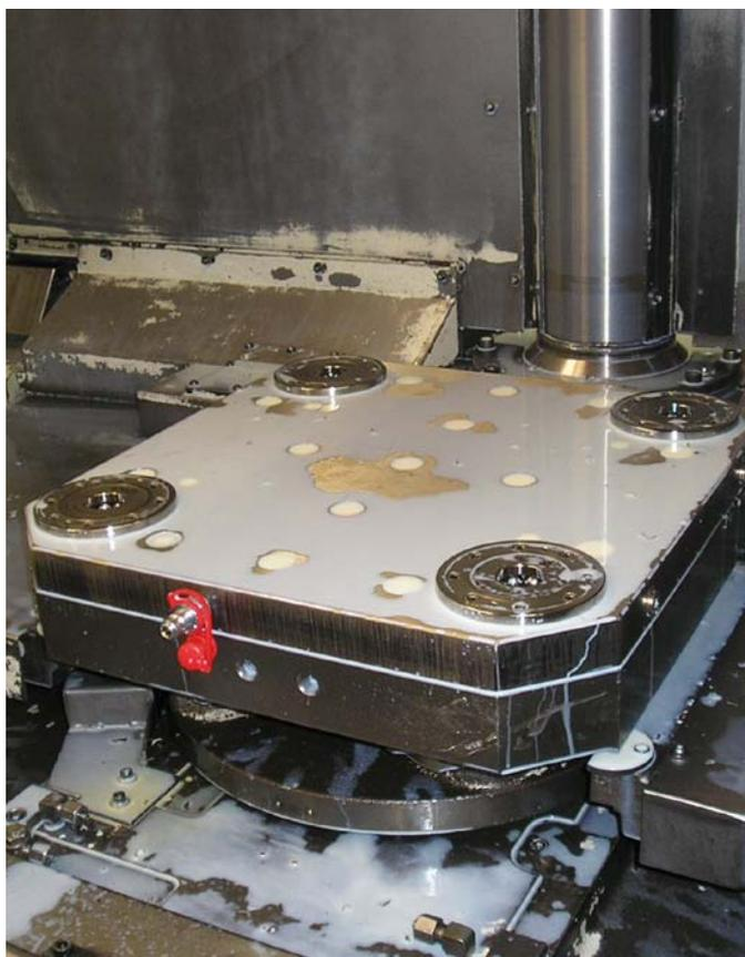
L'espace intérieur des modules de serrage est totalement étanche. Ainsi, le système est protégé de façon optimale contre les fluides et la saleté.
