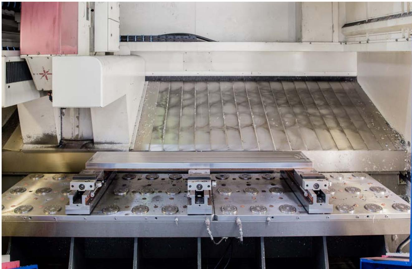
Ajustement simple de plusieurs étaux pour l'usinage de pièces longues.
