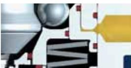
> Si la junta del vástago se vuelve no estanca, la cámara de muelles se llena rápidamente de aceite. Las consecuencias son: El vástago se bloquea y el módulo no se puede abrir. La destrucción del dispositivo de fijación o del módulo de fijación sería entonces inevitable. En este caso, el sistema de seguridad patentado permite que el aceite sea expulsado de la cámara de muelles, de forma que el vástago pueda seguir trabajando.
