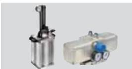
> Regulador hidráulico de presión: Éste convierte la presión neumática en presión hidráulica en una relación de 1:8 para abrir los módulos de fijación hidráulicos. Multiplicador neumático de presión: Su finalidad es reforzar la presión neumática en una relación de 1:2 en módulos de fijación neumáticos, compensando oscilaciones de presión en el conducto de alimentación.
