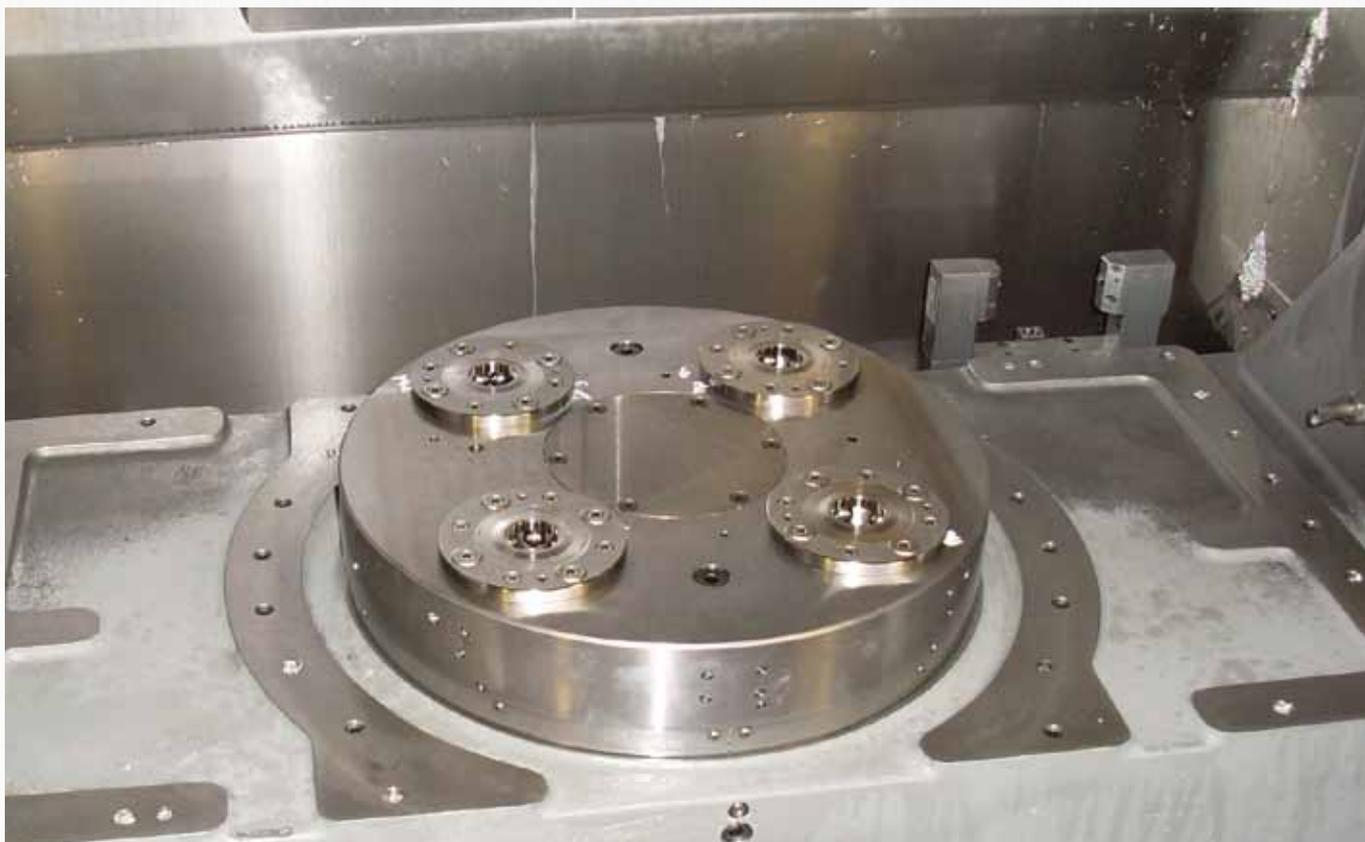
Solución de automatización (N° de pedido 427161) con control de bloqueo y posición, así como sensor de boquilla, para un sistema de producción completamente automatizado con carga por robot.
