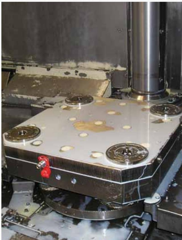
La cámara interior del módulo es completamente hermética. Ello evita la entrada de líquido y suciedad en el sistema.
