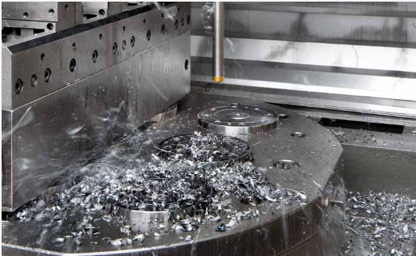
El Clean Stick de AMF en acción: limpieza automatizada del dispositivo de sujeción y la mesa de máquina
