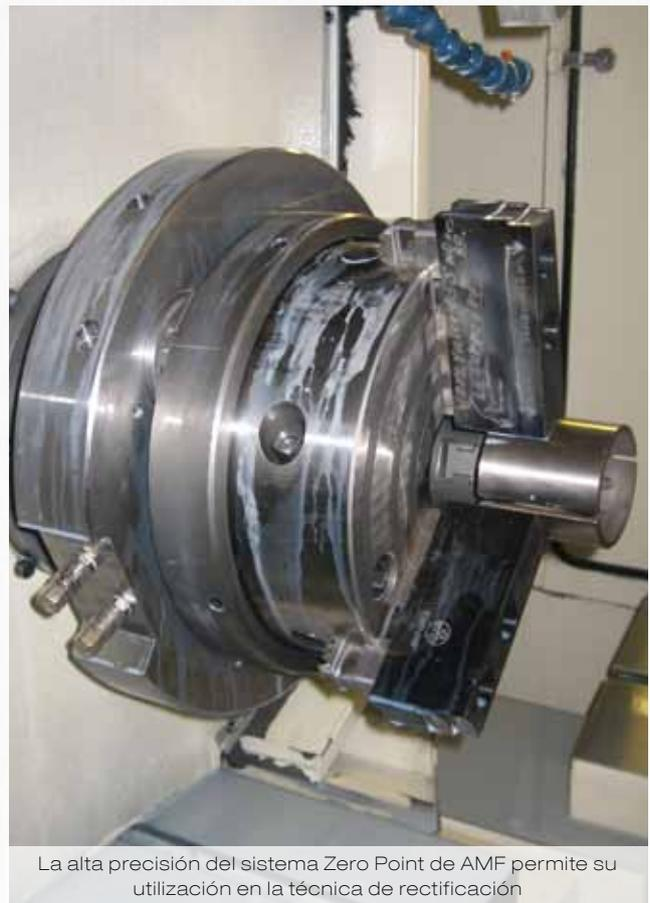
La alta precisión del sistema Zero Point de AMF permite su utilización en la técnica de rectificación
