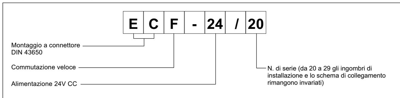
Il connettore ECF è un amplificatore digitale per il comando in anello aperto di valvole on-off.
