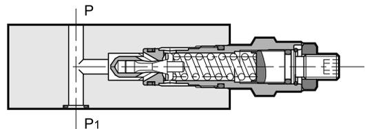
— Das PRM3-Ventil ist ein direktgesteuertes Druckbegrenzungsventil in Modularausführung, dessen Anschlussbild den Normen ISO 4401 entspricht.
