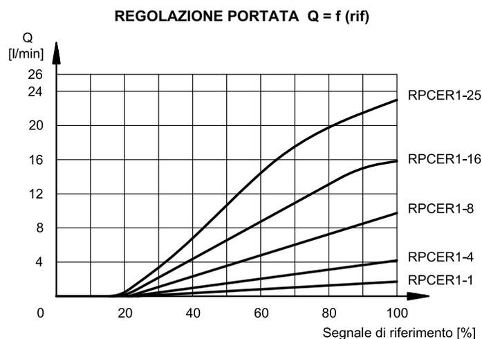
Curve tipiche di regolazione portata A → B in funzione del segnale di riferimento inviato all'unità elettronica di comando.
