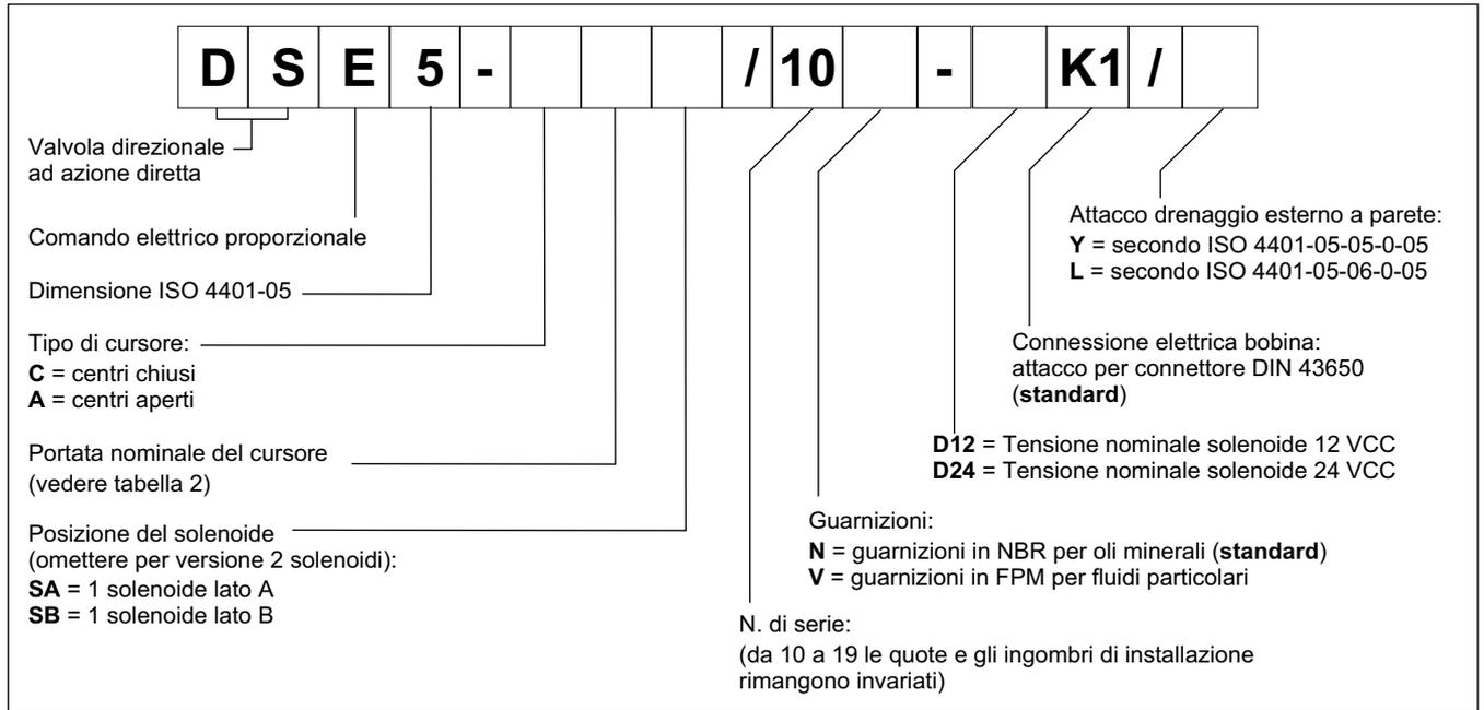
Queste versioni consentono di operare con pressioni sulla bocca di scarico T della valvola fino a **320 bar**.
