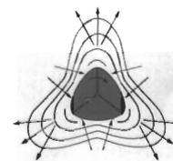
La grande fiabilité du système de sécurité anti-desserrage résulte du processus de formage. Le matériau de base refoulé
