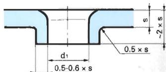
Les tôles minces peuvent être poinçonnées pour recevoir des assemblages vissés.
