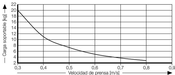
\*\* Carga soportable recomendable en función de la velocidad de la prensa (por unidad de elevación). En caso de cargas mayores se ha de prever un tope fijo externo.
