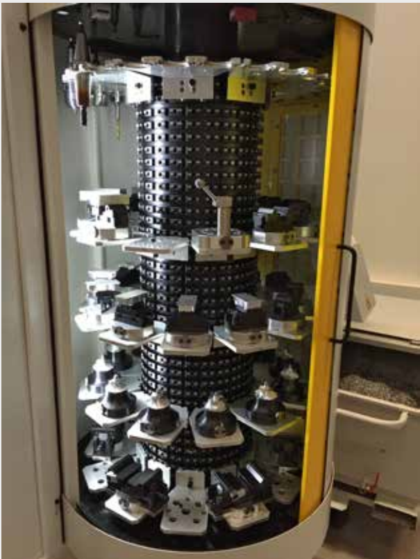
C1 40 C1 40 mit Wendebcken grip in einer Häberle Automation an einer FANUC Robodrill Maschine C1 40 C1 40 with reversible jaw in a Häberle automation on a FANUC Robodrill machine
