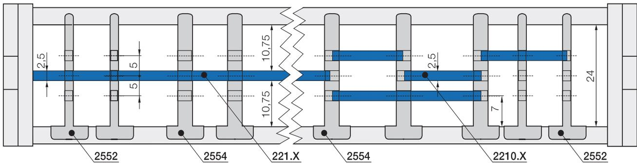
**Trennsteg, Einsteckböden, Fachböden - Standardmäßig werden igus® Trennsteg jedes 2. Kettenglied montiert!**
