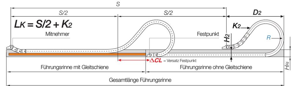
**Hinweis:** Wir empfehlen die Projektierung einer derartigen Anlage von unseren Technikern ausführen zu lassen. Bei Verfahrswegen zwischen 5 und 10 m empfehlen wir eine e-kette® mit größerer freitragender Länge.
