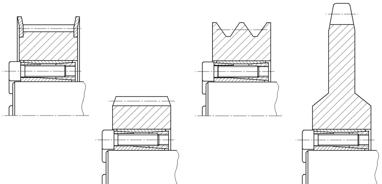
Der **KBS 52 Spannsatz** ist eine reibschlüssige, lösbare Welle-Nabe-Verbindung für Zylindrische Wellen und Bohrungen ohne Passfeder.
