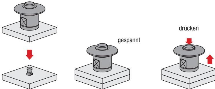
Den Druckspannverschluss über den Spannbolzen setzen ohne den Knopf zu drücken, somit ist der Druckspannverschluss gespannt.
