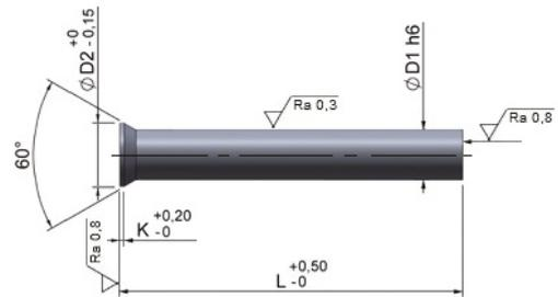
**Esecuzione:** Il gambo del punzone, dopo la ribattitura a caldo ed il rinvenimento, viene finemente rettificato e lappato. La stessa lavorazione di rettifica viene eseguita sulla testa conica. Le tolleranze di finitura, estremamente precise, rendono questi punzoni perfettamente intercambiabili.
