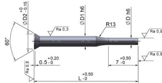
**Esecuzione:** Il gambo del punzone, dopo la ribattitura a caldo ed il rinvenimento, viene finemente rettificato e lappato. La stessa lavorazione di rettifica viene eseguita sulla testa conica. Le tolleranze di finitura, estremamente precise, rendono questi punzoni perfettamente intercambiabili. Il ribasso è concentrico al gambo con una tolleranza massima di 0,01mm.
