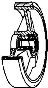
**Rivestimento:** in gomma termoplastica grigia antitraccia, durezza 85+/-4 Shore A, ottime caratteristiche di scorrevolezza ed elasticità.
