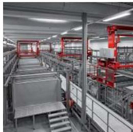
Alle Badparameter werden kontinuierlich überwacht. Die Nachdosierung erfolgt vollautomatisch.
