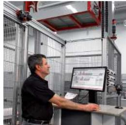
Die gesamte Bedienung der Anlage erfolgt im Untergeschoss. Auf Monitoren werden alle Prozessschritte und Parameter in Echtzeit visualisiert.
