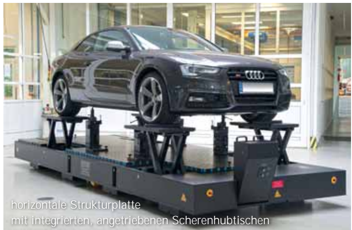
FixBase Boxenkombination mit Konsolenbestückung
