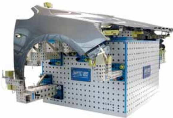
Fixbase Box für Aufnahme Einzelteile Vorderwagen
