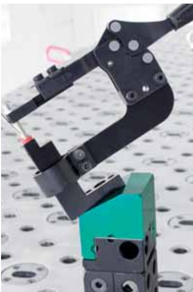
Anwendungsbeispiel Shimblock-oberteil (grün) angeschrägt mit aufgesetzter Rasterschellen-Spanneinheit
