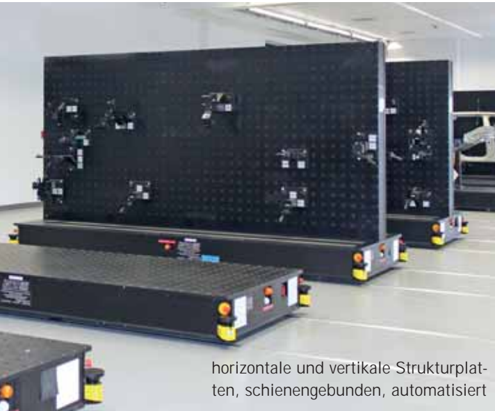
FixBase Boxenkombination mit Konsolenbestückung
