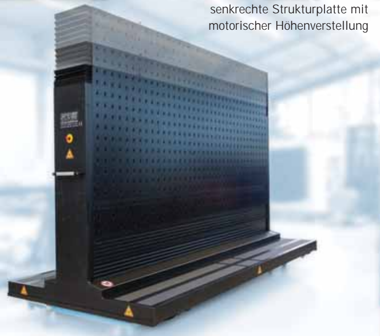
Fixbase Box für Aufnahme Einzelteile Vorderwagen
